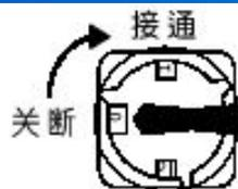
通过接通在控制柜上的主开关后，计算机部分开始起动（装入）操作系统及控制软件。这个装入过程持续数分钟并在 VKCP 的显示屏上以条形的形式显示。
